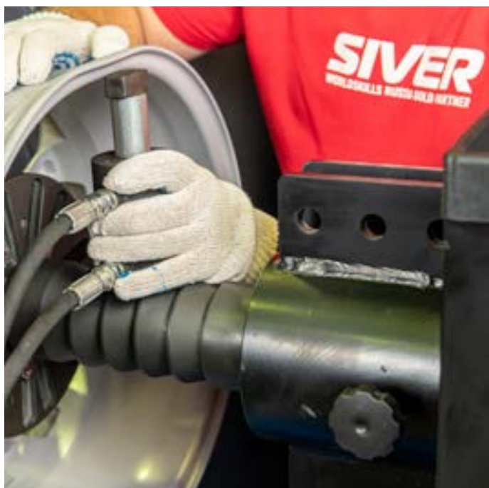
При повреждении от наружной к внутренней стороне обода
