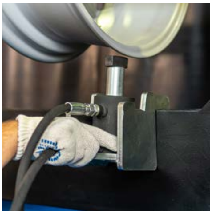
При повреждении от внутренней к наружной стороне обода
